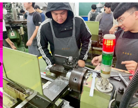
微學分課程「雙缸之氣動引擎之加工技術探討與實作」，透過小單元、短時程但高密度的實作，引導學生在操作中體會加工參數與成果之間的關聯；圖片為於車床加工飛輪
